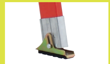
F Tacones de doble acción con goma que previenen derrapes
